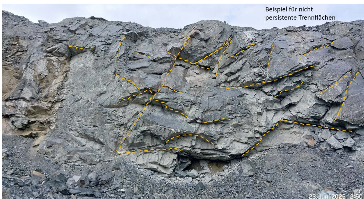
Abb. 6 Beispiel für nicht persistente Trennflächen im Diabas.
