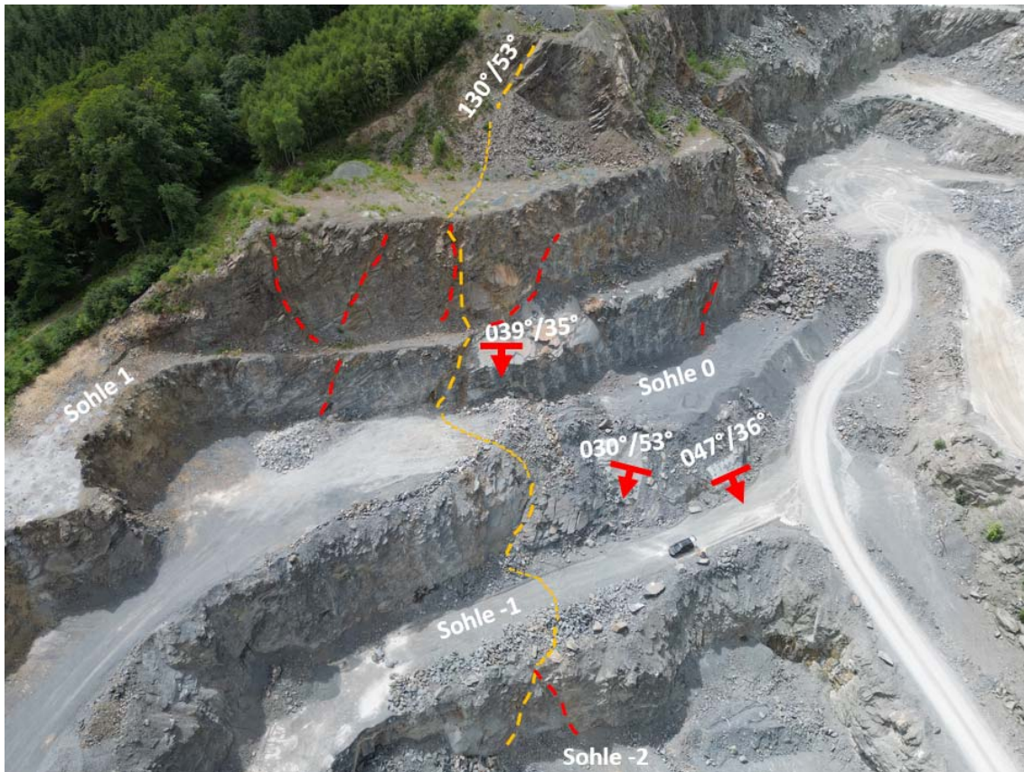
Abb. 14 Großstörung (gelb), Störungen bzw. persistente Trennflächen (rot gestrichelt) im Tonschiefer an der Westwand.
