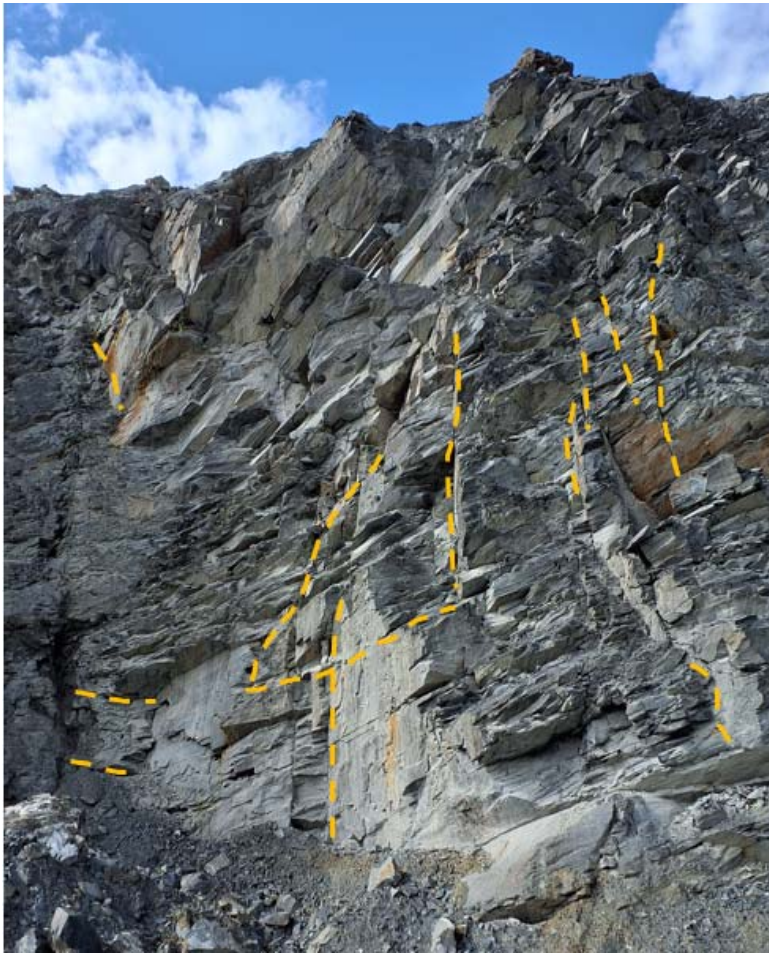
Abb. 7 Beispiel für nicht persistente Trennflächen im Tonschiefer.
