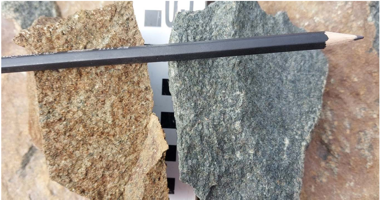
Abb. 4 Verwitterter Diabas (links) und frischer Diabas (rechts).
