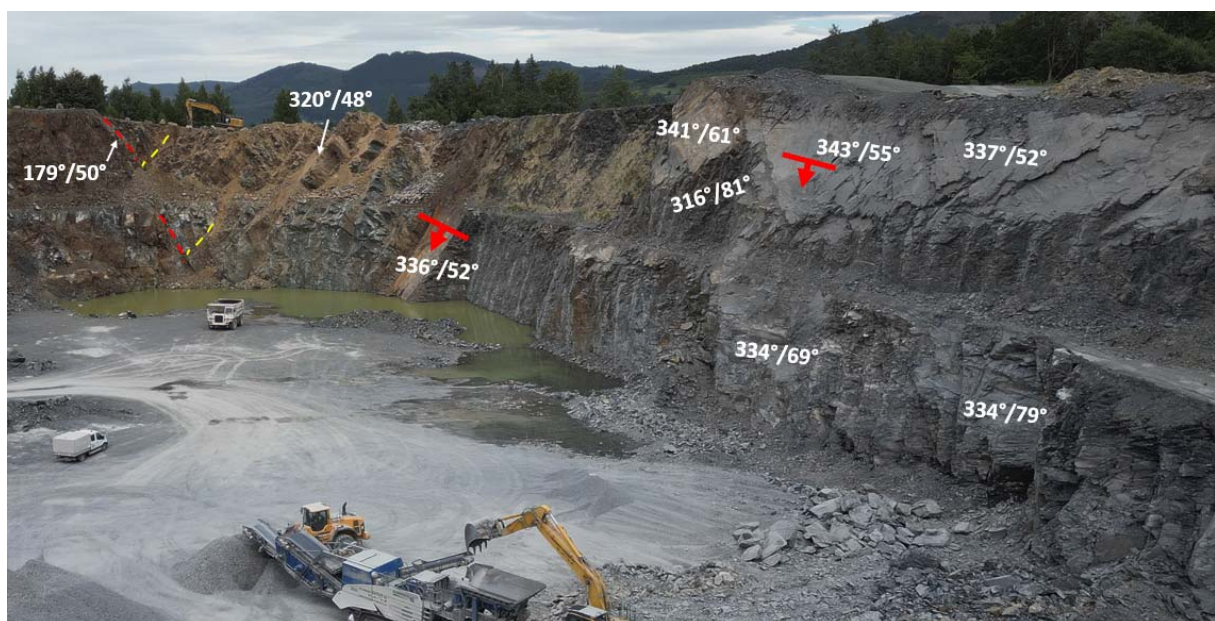
Abb. 9 Kontaktflächen von Diabas auf Tonschiefer an der Südböschung mit Lagerungswerten.
